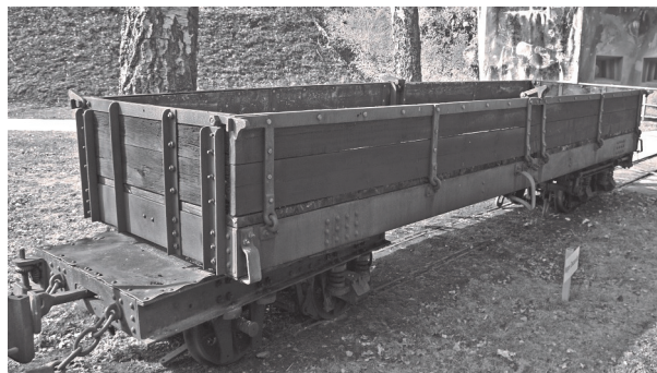
Wagon plate-forme Decauville modèle 1915 à côtés retombants utilisé pour la construction et l'entretien de la voie, charge utile de 10 tonnes.
