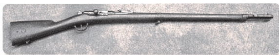
Fusil modèle 1874 dit fusil Gras, longueur du canon 81,5 cm, longueur totale du fusil 113 cm.
